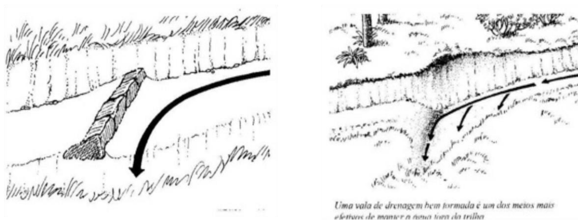
Figura 35 - Modelos de drenagem adequados em trilhas.
